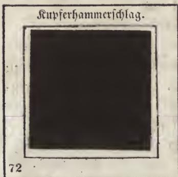
Sammelt man den Kupferhammerschlag, der beim Erhigen von Kupferplatten und raschem Abkühlen im Wasser sich ablöst und auf dem Boden des Gefäßes lagert, mischt ihn mit Kohle und glüht das Gemisch in einem Tiegel, so erhält man metallisches Kupfer. Der Hammerschlag ist nämlich ein durchs Verbrennen des Kupfers entstandenes Sauerstoffkupfer oder Kupferoryd, dem die Kohle in der Hitze den Sauerstoff wieder entzieht und das Kupfer herstellt.
